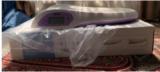
Gambar 1. Alat antropometri digital untuk bayi dari ONEMED yang sudah diintegrasikan dengan aplikasi SmartMyBaby
