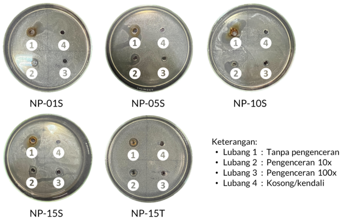
GAMBAR 7. Pengujian nanopartikel perak sebagai material antibakteri pada bakteri Escherichia coli .
