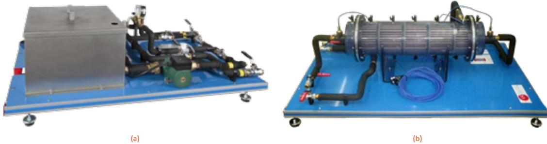
GAMBAR 1. Rangkaian peralatan STHE yang digunakan pada penelitian, (a) "TIUS"; (b) "TICT".
