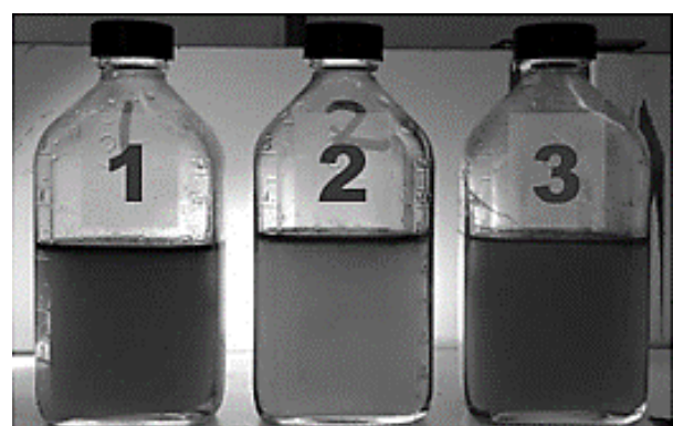
GAMBAR 4. Sampel lapangan offshore Attaka: (1) tanpa injeksi bahan kimia; (2) injeksi flokulan; (3) injeksi koagulan.
