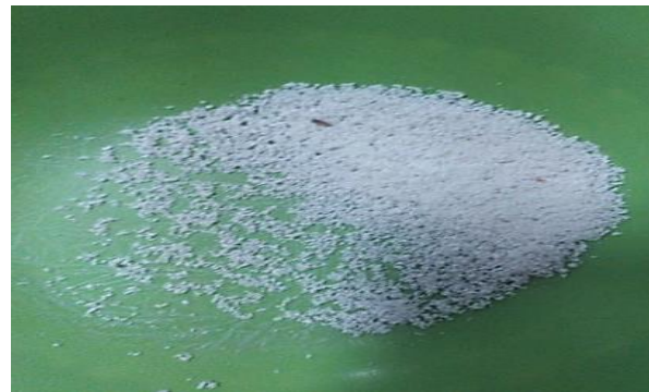
Gambar 1. Carboxymethyl cellulose (CMC) hasil proses sintesis jerami padi dengan natrium monokloroasetat
