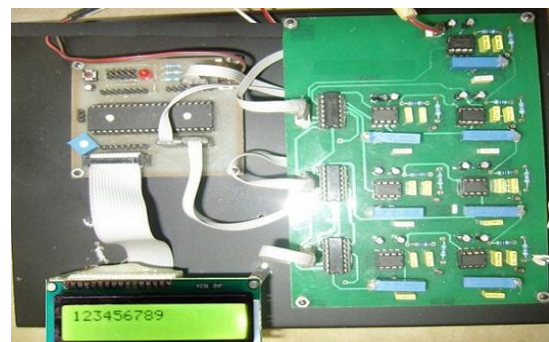
Gbr. 9 Detektor dan Penampil paket kode DTMF Custom
