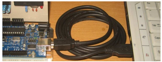
Gbr. 8 Antarmuka board Arduino dengan PC
