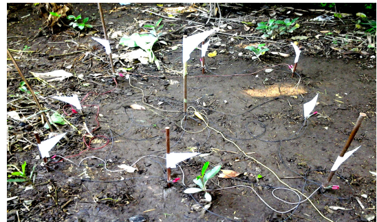
Gbr. 10 Foto Pengukuran Resistans Pentanahan 1 Batang Pentanah dengan Elektrode Sangkar Persegi 8 Batang Penyusun
