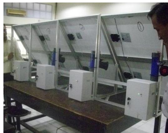
Gbr. 6 Implementasi KYL-200L pada node transceiver yang dipasang pada titik terluar habitat gajah.
