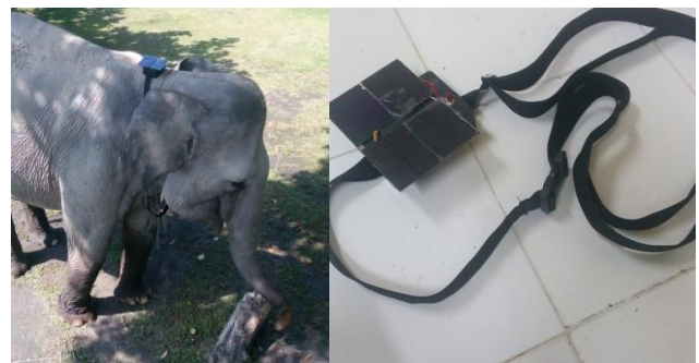
Gbr. 5 Implementasi transmitter KYL-200L sebagai sensor pada kalung gajah.
