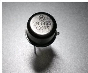
Gbr. 4 Bentuk fisik transistor 2N3866.
