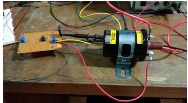
Gbr. 5 Alat pembangkitan tegangan tinggi dengan metode flyback.
