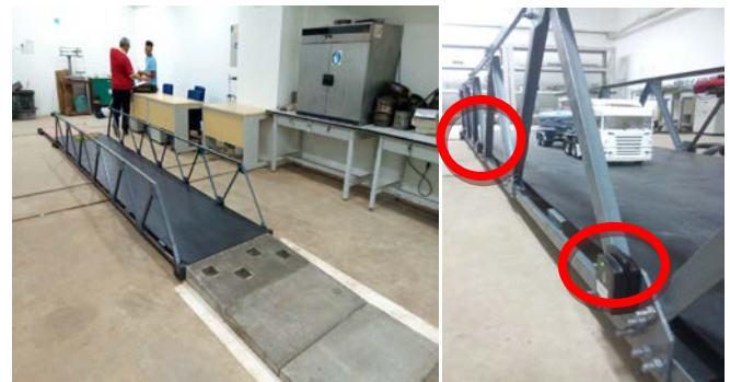
Gbr. 6 Konstruksi jembatan test-bed , pemasangan simpul sensor nirkabel (lingkaran merah), dan pengujian menggunakan truk Scania 1:14 RC.
