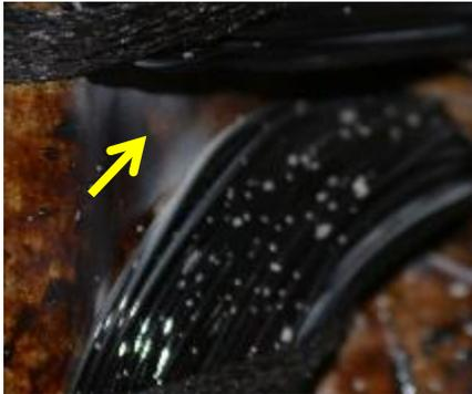
Gbr. 7 Lapisan putih pada permukaan *groundwall insulation*.
