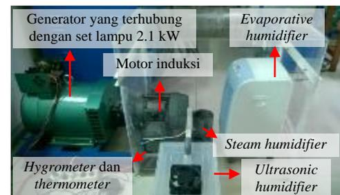
Gbr. 4 Konstruksi pengujian skema 3.
