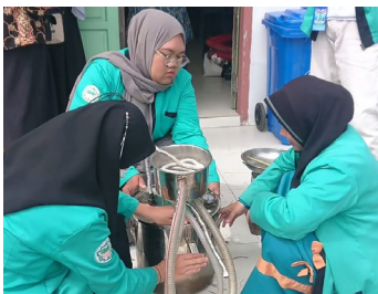
Gambar 6. Pemasangan alat penyulingan, proses penyulingan dalam suhu 100 °C, dan hasil uap keluar melalui selang pendinginann yang di tampung kedalam wadah. Sumber: dokumentasi pribadi.
