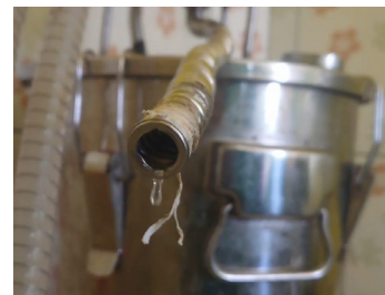
Gambar 6. Pemasangan alat penyulingan, proses penyulingan dalam suhu 100 °C, dan hasil uap keluar melalui selang pendinginann yang di tampung kedalam wadah. Sumber: dokumentasi pribadi.
