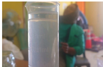
Gambar 7. Uap yang telah terkumpul (hydrosol) di wadah lalu dipindahkan ke gelas ukur, cairan hydrocol didiamkan selama 1 jam untuk memisahkan air dan minyak atsirinya. Minyak yang telah naik ke permukaan diambil menggunakan pipet dan dipindah ke dalam botol ukuran 5 ml. Sumber: dokumentasi pribadi.
