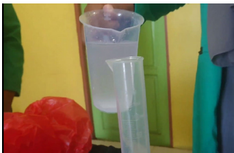
Gambar 7. Uap yang telah terkumpul (hydrosol) di wadah lalu dipindahkan ke gelas ukur, cairan hydrocol didiamkan selama 1 jam untuk memisahkan air dan minyak atsirinya. Minyak yang telah naik ke permukaan diambil menggunakan pipet dan dipindah ke dalam botol ukuran 5 ml. Sumber: dokumentasi pribadi.
