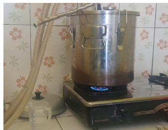
Gambar 6. Pemasangan alat penyulingan, proses penyulingan dalam suhu 100 °C, dan hasil uap keluar melalui selang pendinginann yang di tampung kedalam wadah. Sumber: dokumentasi pribadi.
