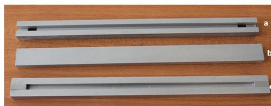
Gambar 2. Cetakan dan pemegang spesimen ekspansi termal linier. a. pemegang spesimen, b. tutup cetakan, c. cetakan.
