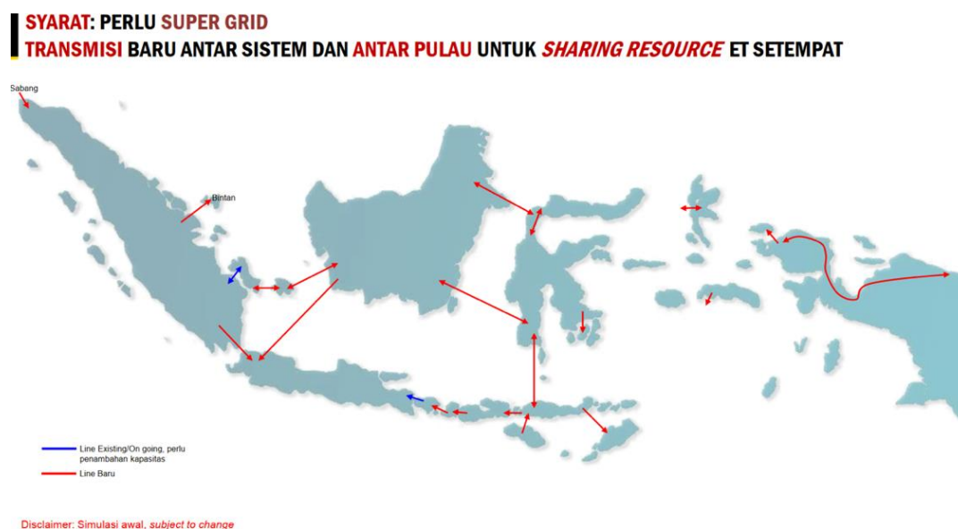
Gambar 6. Konsep Jaringan Super Grid Penghubung Transmisi Jaringan Listrik Antar Pulau di Indonesia (ESDM, 2021)
