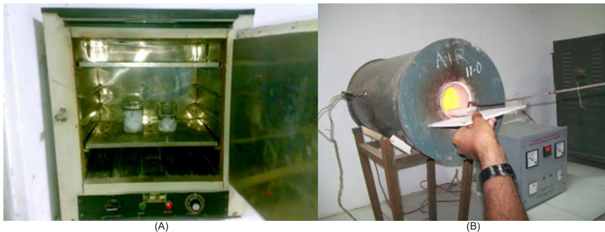
Gambar 2. Sintesis CaO: (A) Cangkang telur mendidih dalam oven; (B) Kalsinasi HA dalam tungku tabung. 25
