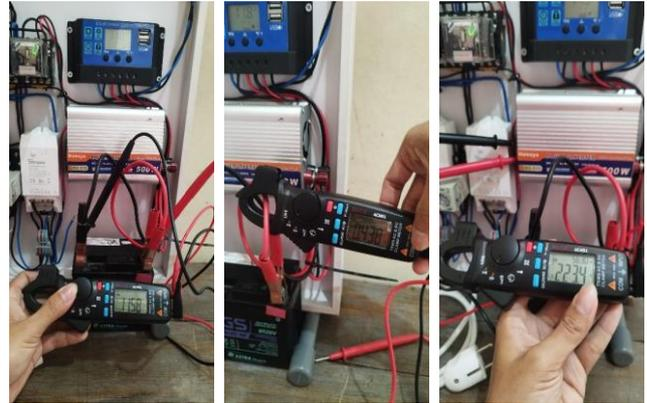
Gambar 15. Pengujian inverter
