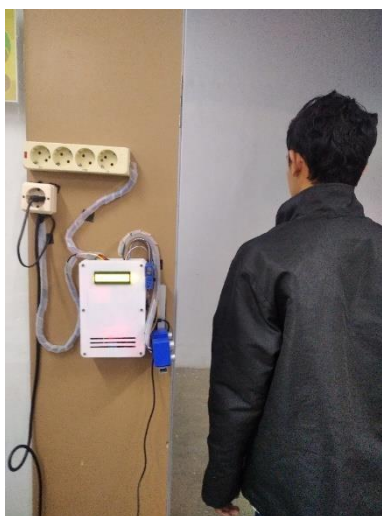
Gambar 6. Pengujian sensor HC-SR04 dalam mendeteksi orang yang masuk dan keluar ruangan
