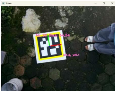
Gambar 21. Pengujian kamera *smartphone*
