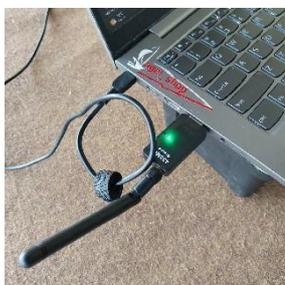
Gambar 18. Status koneksi telemetri *ground*
