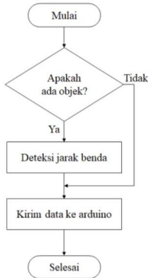
Gambar 3. 1 Flowchart pengukuran jarak benda
