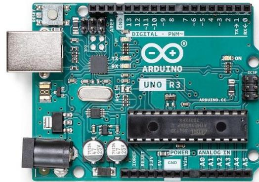
Gambar 2. 4 Arduino Uno<sup>[8]</sup>
