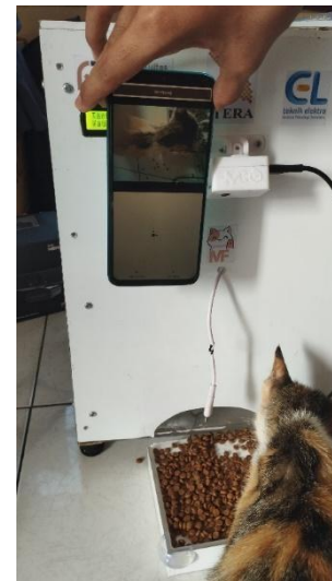
Gambar 10. Kamera berhasil menangkap gambar dan menampilkannya di aplikasi secara real-time
