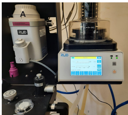
Gambar 4. Mesin anestesi RWD tipe R 620 S-1 (RWD Life Science, China), dilengkapi dengan ventilator mekanik untuk membantu pernafasan hewan apabila berhenti pada saat operasi. A. Vaporizer dan ventilator, B. Pengaturan ventilator pada berat kucing 3 kg dan kondisi hewan apnea
