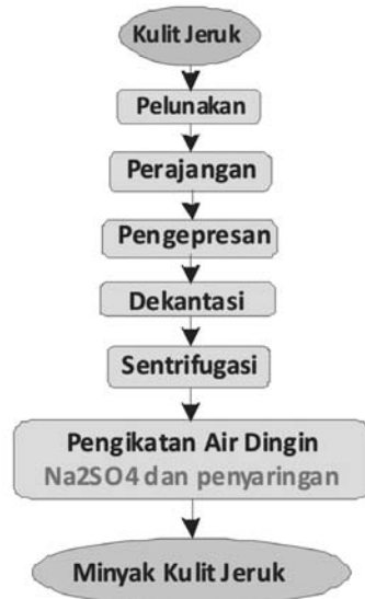
Gambar 1. Diagram Alir Proses Pengambilan Minyak Kulit Jeruk
