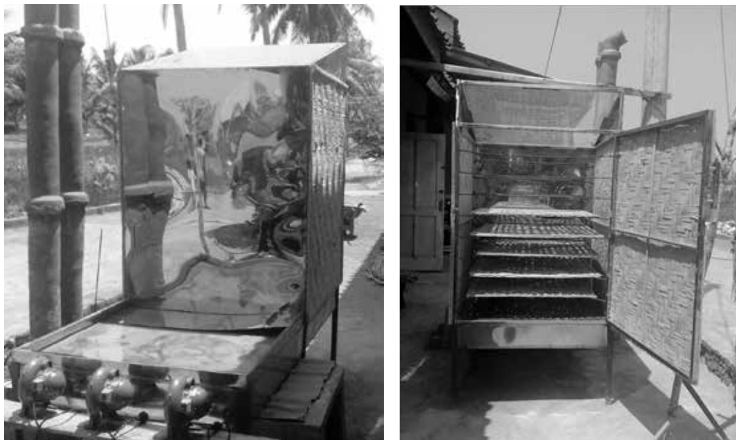
Gambar 4. Pengering ikan asin : (A) tampak depan; (B) tampak belakang
