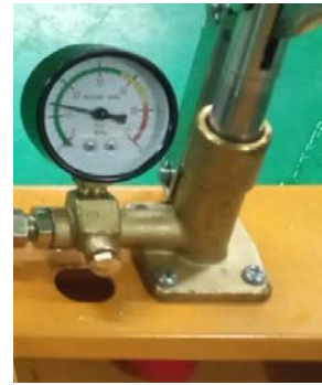
Gambar 14. Pembacaan pressure gauge saat pengujian tekanan hidrostatik 14 bar.
