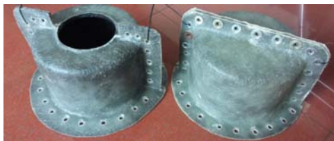
Gambar 8. Cetakan tabung gas komposit.
