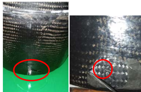
Gambar 15. Kerusakan akibat tekanan hidrostatik.
