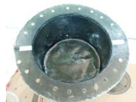
Gambar 10. Cetakan tabung gas komposit yang telah dilapisi serat karbon dan resin.
