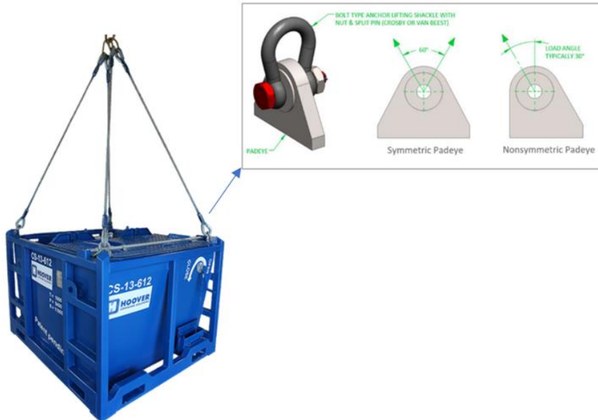
Gambar 1. CCU dengan lifting dan padeye (Ferguson, 2019)
