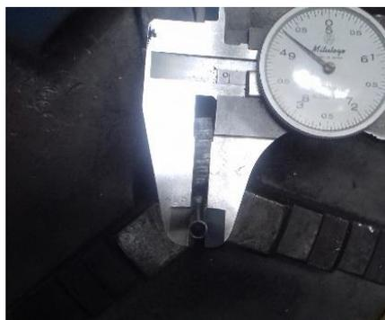
Gambar 3. Proses pengukuran *minitube*
