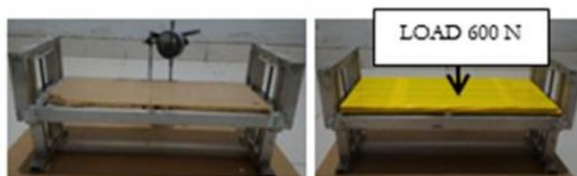
Gambar 2. Proses pengujian tempat Tidur skala 1:5
