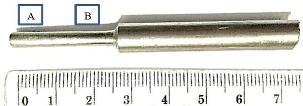
Gambar 5. Ketidakhomogenan ukuran diameter *minitube*, bagian A memiliki diameter yang lebih besar di bandingkan bagian B
