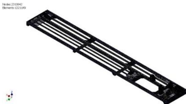
Gambar 2. *Frame meshing* untuk *wire winding machine*
