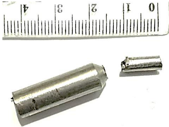
Gambar 4. Patah pada minitube disebabkan oleh proses boring dan face turning tidak dilakukan secara berurutan
