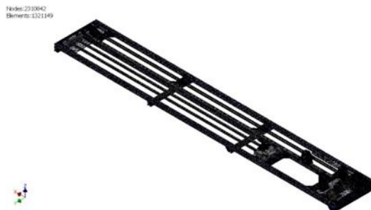
Gambar 2. Frame meshing untuk wire winding machine
