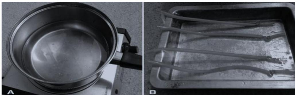
**Gambar 3.** (A) Penampilan gelatin balistik yang benar-benar meleleh. (B) Lapisan pertama diaplikasikan pada panci dengan pipa lateks di tempat.
