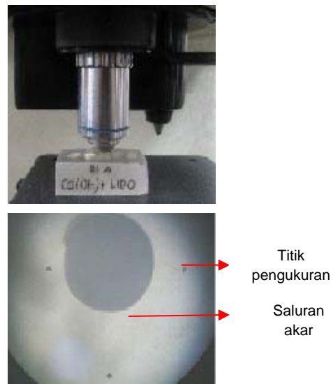
Gambar 1. A Indentasi setelah perlakuan, B. Pengukuran kekerasan mikro pada tiga titik yang mengelilingi akar gigi.
