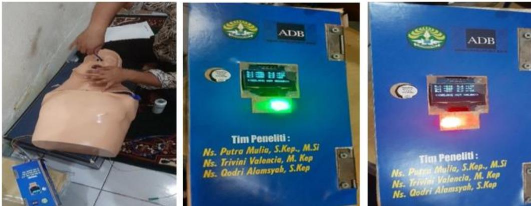
Gambar 3. Proses pengetesan sistem *smart sensor*. LED hijau menyala jika tindakan benar. LED merah menyala jika tindakan salah.
