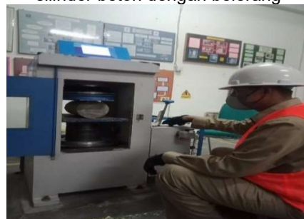
Gambar 6. Pengujian tekan sampel silinder beton
