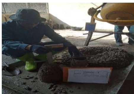
Gambar 1. Pembuatan benda uji (pengujian slum)
