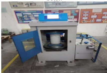
Gambar 5. Pengujian tekan sampel silinder beton
