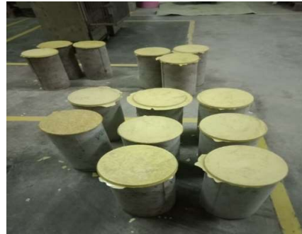
Gambar 4. Perataan permukaan sampel silinder beton dengan belerang
