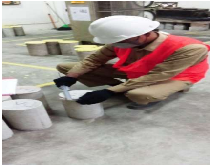
Gambar 3 pengukuran dimensi sampel beton
