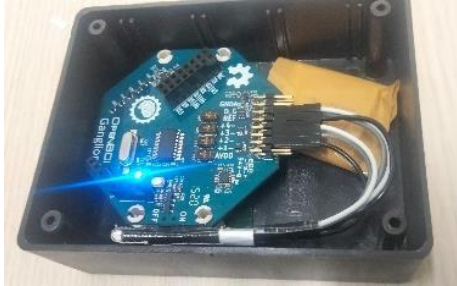
Gambar 2. OpenBCI di dalam Casing Box dan dipasang impedansi tiruan
