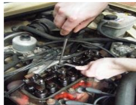
Gambar 2. Penyetelan kerenggangan katup.
