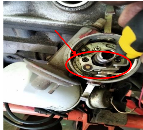
Gambar 1. Penggantian platina baru
