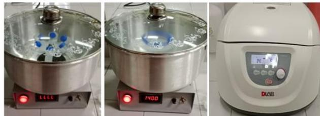
Gambar 6. Preparasi sampel Katalis Ni.CaO dan tanah sedang berlangsung menggunakan *centrifuge* alternatif dan *centrifuge* pabrikan merk DLAB type DM 0412
