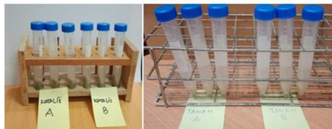
Gambar 7. Hasil preparasi sampel Katalis Ni.CaO dan tanah menggunakan *centrifuge* alternatif dan *centrifuge* pabrikan merk DLAB type DM 0412
