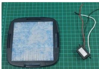
Gambar 4. Hepa Filter dan Ionizer sebagai filter
