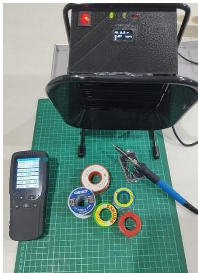
Gambar 8 . Tahapan Pengujian prototype alat menggunakan 5 sampel tenol
