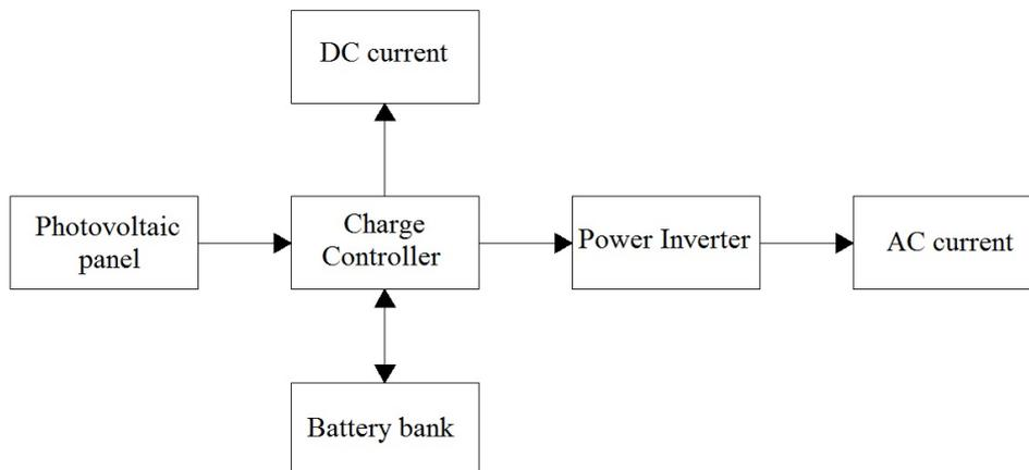
Gambar 5 Blok diagram pada sistem energy fotovoltaik
