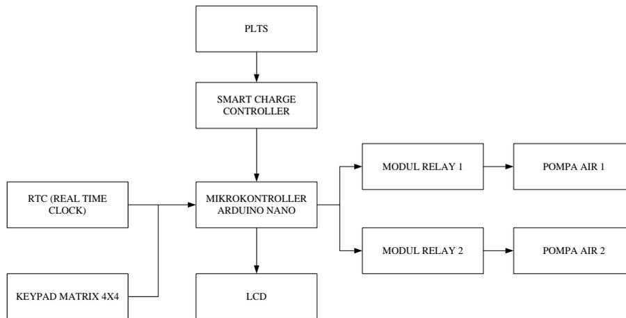
Gambar 4 Blok diagram sistem irigasi otomatis
