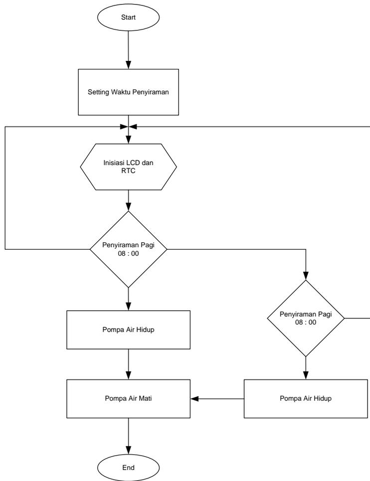
Gambar 3 Flowchart Sistem Irigasi Otomatis
