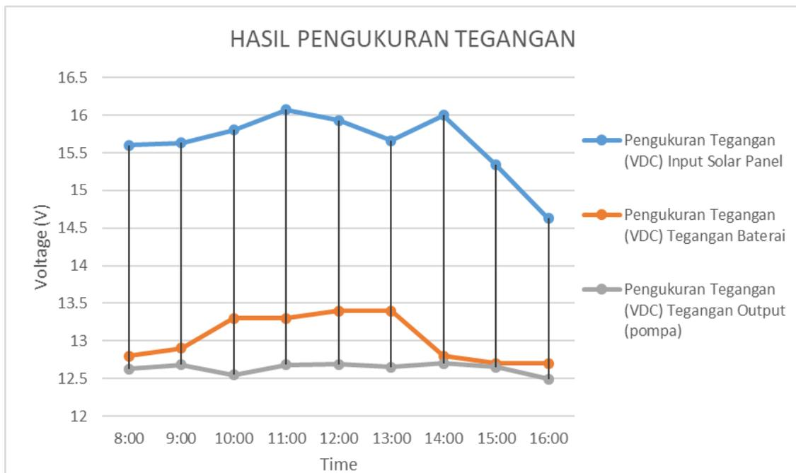
Gambar 7 Perbandingan tegangan pada solar panel, baterai, dan keluaran pompa
