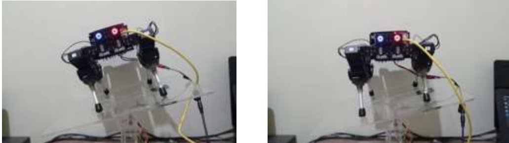
Gambar 10. a. Posisi awal robot dan bidang environment ketika akan melakukan penyeimbangan sumbu roll . b. Robot selesai melakukan penyeimbangan untuk sumbu roll
