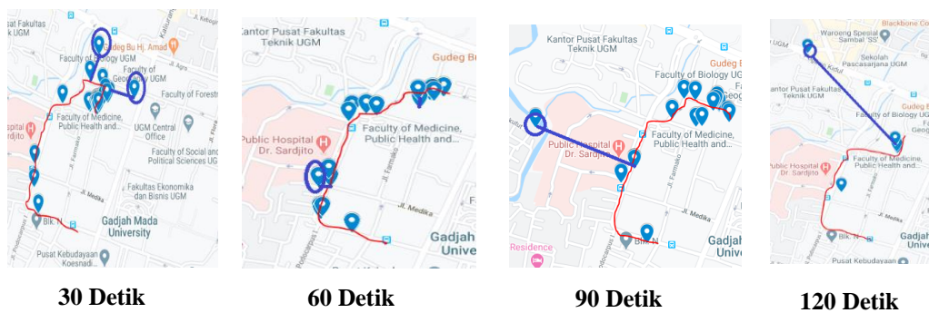
Gambar 6. Map-matching dan Penentuan Titik Error pada Locking GPS
