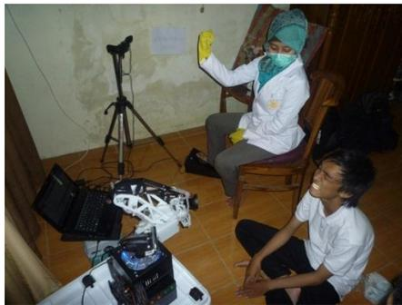
Gambar 2 Keseluruhan perangkat keras sistem kendali gerak robot lengan *dental light*
