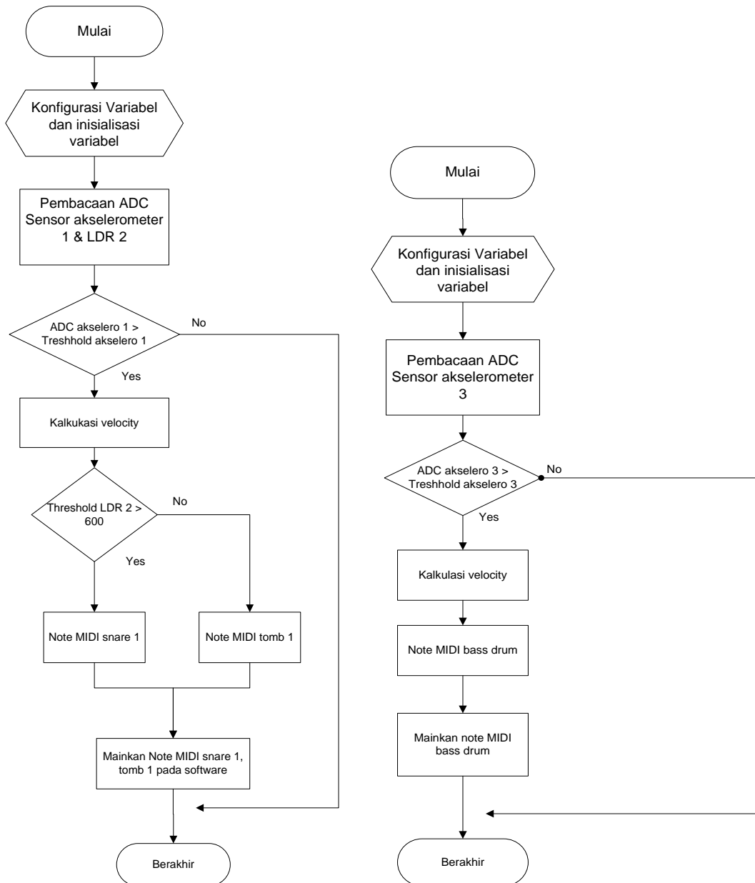
Gambar 4 Flowchart pengendali virtual drum pada bagian stik A dan sandal A
