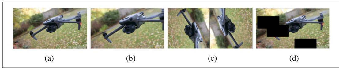
Figure 1 Data Augmentation Type (a) Original (b) Crop (c) Rotate 90° (d) Cutout
