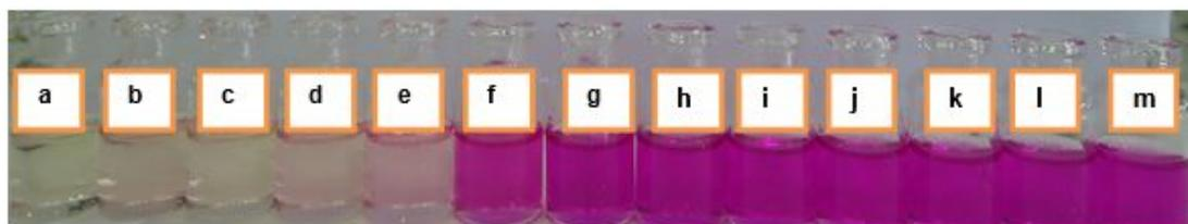
Fig 11. Color change LOD of sensor 1; a. 0 eq, b.  $10^{-5}$  eq, c.  $10^{-4}$  eq, d.  $10^{-3}$  eq, e.  $10^{-2}$  eq, f.  $10^{-1}$  eq, g. 1 eq, h. 5 eq, i. 10 eq, j. 30 eq, k. 50 eq, l. 70 eq, m. 90 eq
