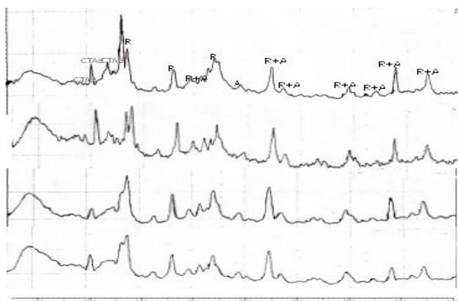
**Gambar 3** Spektrum XRD untuk grafit/TiO<sub>2</sub> pada 4 hari sintesis dengan [CTABr] 4 mM (a), 8 mM (b), 12 mM (c), 16 mM (d)
