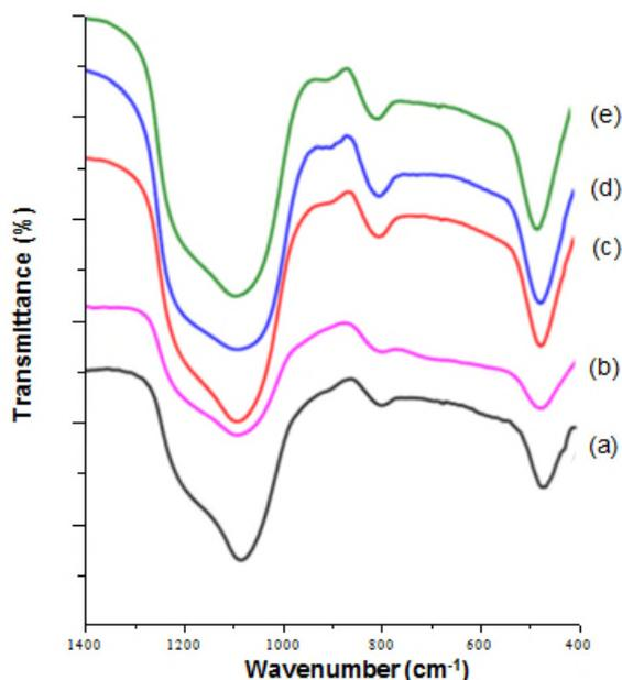
**Fig 2.** FTIR spectra: (a) AM; (b) 1%  $\text{AlCl}_3/\text{AM}$ ; (c) 5%  $\text{AlCl}_3/\text{AM}$ ; (d) 10%  $\text{AlCl}_3/\text{AM}$ ; (e) 15%  $\text{AlCl}_3/\text{AM}$
