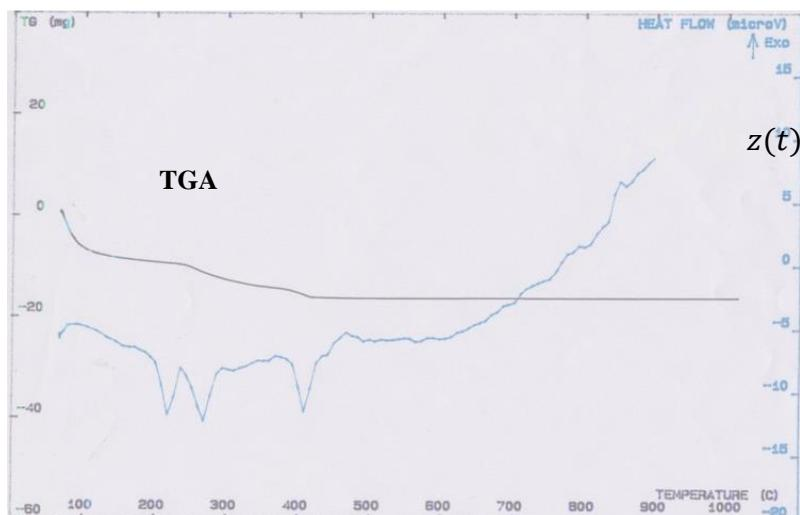
**Gambar 1.** Grafik DTA-TGA dari prekursor LiFePO<sub>4</sub>/C
