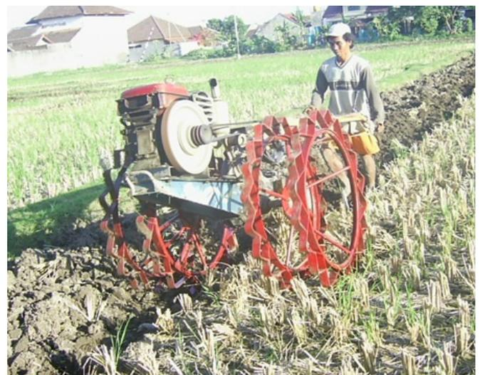
Gambar 4. Desain roda sirip lengkung untuk traktor tangan.
