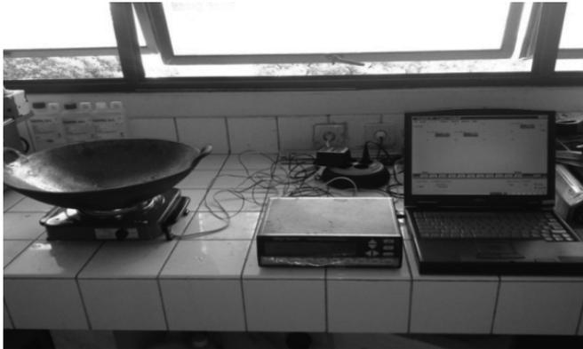
Gambar 1. Perangkat alat untuk mengukur suhu yang terdiri dari *data logger* 8 channel dan komputer.
